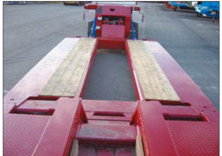
Faymonville hat für seine Baureihe „Megamax“ neue Varianten entwickelt. Die erste dieser Entwicklungen betrifft den Megamax Z1+5, der eine flache Ladefläche mit Schwanenhals besitzt und der nun neu auch hydraulisch von 2,75 Meter auf 3,85 Meter erweitert werden kann. Dieses Tiefbett, Hydro-
