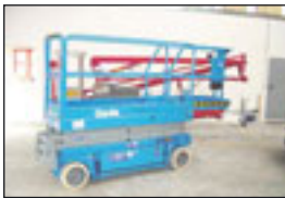
Scherenbühne Genie GS 2032, Bj.: 2002 , Arbeitshöhe: 8,10 m, Korbmaße: 2,35x0,76 m, Hublast: 360 kg, Gewicht: 1.560 kg, Batterie, ausziehbare Plattform, schmale Bauweise.
