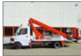
LKW-Teleskopbühne Wumag WT 185 auf MB 410, Bj.: 1994 , Arbeitshöhe: 18,50 m, seitl. Reichweite: 9,50 m, Korbmaße: 1,23x0,83 m, Hublast: 200 kg, Gewicht: 4.300 kg, Diesel, schräge Stützen, ATM 2003
