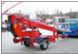
Anhängerbühne Dino 150 T, Bj.: 2002 , Arbeitshöhe: 15,00 m, seitl. Reichweite: 10,00 m, Korbmaße: 1,30x0,70 m, Hublast: 215 kg, Gewicht: 1.620 kg, 220 Volt, hydraul. Stützen, Fahrtrieb.
