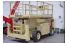
Scherenbühne Grove SM 4688 XT, Bj.: 1995 , Arbeitshöhe: 14,20 m, Korbmaße: 4,20x2,32 m, Hublast: 680 kg, Gewicht: 4.800 kg, Diesel, Allrad, ausziehbare Plattform.
