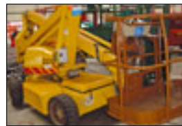
Gelenkteleskopbühne Terex TA 33 E, Bj.: 1999 , Arbeitshöhe: 12,00 m, Korbmaße: 1,18x0,67 m, Hublast: 225 kg, Gewicht: 5.090 kg, Batterie, drehbarer Korb.
