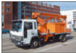
LKW-Teleskopbühne Ruthmann T 130 auf Volvo FL 611, Bj.: 1986 , Arbeitshöhe: 15,00 m, seitl. Reichweite: 11,00 m, Korbmaße: 1,60x0,80 m, Hublast: 250 kg, Gewicht: 8.000 kg, Diesel, hydraul. Stützen
