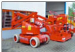
Gelenkteleskopbühne Terex TA 30 N, Bj.: 1998 , Arbeitshöhe: 11,10 m, Korbmaße: 1,20x0,60 m, Hublast: 225 kg, Gewicht: 4.800 kg, Batterie, drehbarer Korb.
