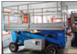
Scherenbühne Genie V 2470, Bj.: 1997 , Arbeitshöhe: 9,30 m, Korbmaße: 3,35x1,78 m, Hublast: 550 kg, Gewicht: 2.500 kg, Batterie, ausziehbare Plattform.
