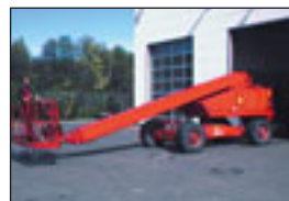
Teleskopbühne Snorkel TBA 60 R 4x4, Bj.: 1994 , Arbeitshöhe: 20,30 m, Korbmaße: 2,40x0,76 m, Hublast: 230 kg, Gewicht: 9.600 kg, Diesel, Allrad, drehbarer Korb.
