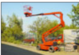
Gelenkteleskopbühne Euro Access MZ 14-46 SP, Bj.: 2000 , Arbeitshöhe: 14,00 m, Korbmaße: 1,20x0,60 m, Hublast: 215 kg, Gewicht: 3.900 kg, Diesel, neuwertig.
