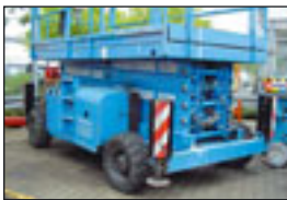
Scherenbühne Haulotte H18SDX, Bj.: 2000 , Arbeitshöhe: 18,00 m, Korbmaße: 6,00x1,80 m, Hublast: 500 kg, Gewicht: 7.160 kg, Diesel, Allrad, ausziehbare Plattform.
