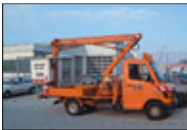
LKW-Teleskopbühne Ruthmann KS 90 auf MB 307, Bj.: 1988 , Arbeitshöhe: 11,00 m, seitl. Reichweite: 5,80 m, Korbmaße: 1,20x0,60 m, Hublast: 150 kg, Gewicht: 3.500 kg, Diesel, hydraul. Stützen
