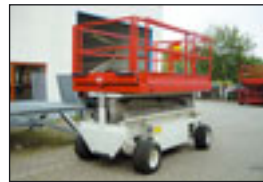
Scherenbühne Holland Lift HL X 108 DL 18, Bj.: 1992 , Arbeitshöhe: 12,60 m, Korbmaße: 3,22x1,54 m, Hublast: 500 kg, Gewicht: 4.570 kg, Diesel, verschiebbare Plattform.
