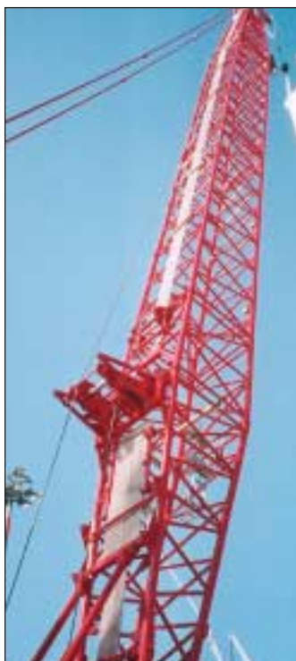
Manitowoc konzentriert sich voll auf den Kranmarkt: der neue 250 Tonnen Schwerlast-Raupenkran Modell 15000.
