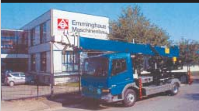
Der AK 41/6000 SPS von Böcker erweitert das Angebot von Böcker im Alukranbereich mit sechs Tonnen deutlich nach oben
