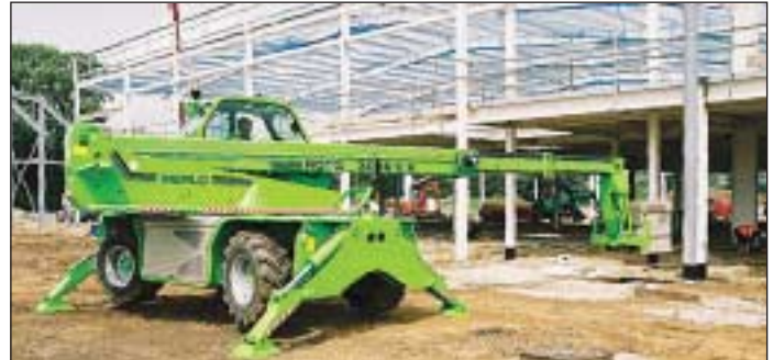
Nicht nur die Hubhöhe von 25 Metern des Merlo-Roto 40.25 ist gefragt. Auf bis zu 22 Meter Reichweite kommt das Gerät
