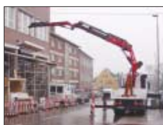
HMF Schwerlastkran Odin mit 52 Metertonnen.
