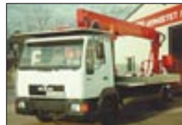
LKW-Teleskopbühne GSR 220 TJ auf MAN 8.153,Bj: 1996, Arbeitshöhe: 22 m, seilf.Reichweite: 13 m, Hublast: 200 kg, Gewicht: 7.210 kg, Diesel, drehbarer Korb, Korbarm.
