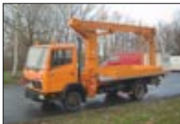
LKW-Teleskopbühne Ruthmann K 115 auf MB 709, Bj: 1986, Arbeitshöhe: 14,50 m, seilf.Reichweite: 8,50 m, Hublast: 200 kg, Gewicht: 6.500 kg, Diesel, hydraul.Stützen.
