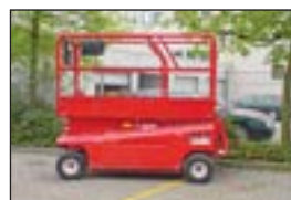
Scherenbühne Condor V 2053 XL, Bj: 2000, Arbeitshöhe: 8,10 m, Hublast: 567 kg, Gewicht: 2.100 kg, Batterie, ausgesch. Reifen, Prop.-Steuerung.
