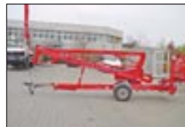
Anhängerarbeitsbühne Litra 120 G, Bj: 2000, Arbeitshöhe: 12 m, seilf.Reichweite: 4,50 m, Hublast: 215 kg, Gewicht: 1.200 kg, 220 Volt, hydraulische Stützen.
