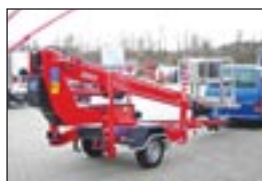
Anhängerbühne Dino 150 T, Bj: 2002, Arbeitshöhe: 15 m, seilf.Reichweite: 10 m, Hublast: 215 kg, Gewicht: 1.620 kg, hydraul.Stützen, Fahrtrieb.
