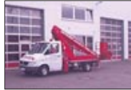
LKW-Teleskopbühne Wumag WT 175 auf MB 308, Bj.: 1999, Arbeitshöhe: 17,50 m, seilf.Reichweite: 8,30 m, Hublast: 200 kg, Gewicht: 3.345 kg, Diesel, hydraul. Stützen.
