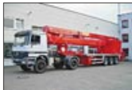
LKW-Teleskopbühne Ruthmann TTS 590 auf MB 2043, Bj: 1987/2001, Arbeitshöhe: 60 m, seilf.Reichweite: 29 m, Hublast: 500 kg, Gewicht: 41.800 kg, Diesel, generalüberholt in 2001.
