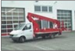
LKW-Teleskopbühne Ruthmann TL 140 auf MB 308, Bj.:1995 & 96, Arbeitshöhe: 16 m, seilf.Reichweite: 11,70 m, Hublast: 200 kg, Gewicht: 3.240 kg, Diesel, 220 V im Korb.
