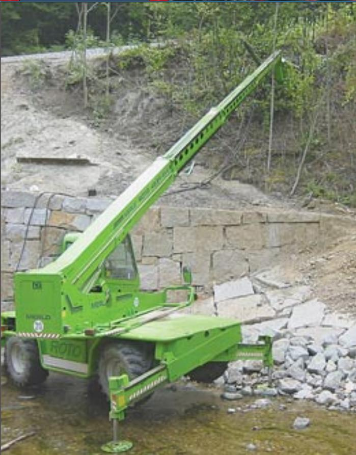
Bei der Rekonstruktion und Stabilisierung der auch das Weißeritztal durchlaufenden Bahntrasse setzte die Tröbitzer Spezialtiefbau und Umwelttechnik GmbH auf einen Merlo Roto 40.21 EVS aus dem Fuhrpark von Theisen. Insgesamt 100 Erdnägel zwischen vier und 10,5 Metern Länge mussten in den Hang eingebracht werden.
