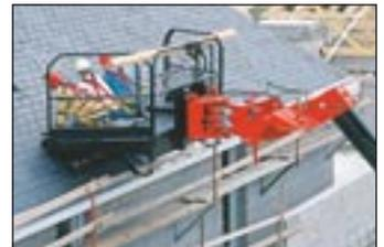
Manitou hat eine „Dachdecker-Arbeitsbühne“ entwickelt. Der Anbau für Teleskoplader der Maniscopic-Reihe ermöglicht es, Arbeiten am Dach von der Bühne aus zu absolvieren.
