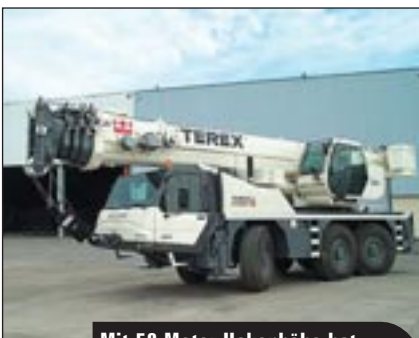
Mit 58 Meter Hakenhöhe hat der Terex AC 55 ein Wörtchen mit zu reden
