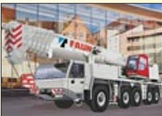
Tadano stellt die neuen Tadano Faun All Terrain Crane Typ ATF 160-5 und ATF 110-5 sowie den Geländekran GR-700 EXL aus. Der neue 5-Achser Tadano Faun ATF 160-5 verfügt über eine maximale Tragfähigkeit von 160 Tonnen und ist mit einem 60 Meter Ausleger mit einem 1-
