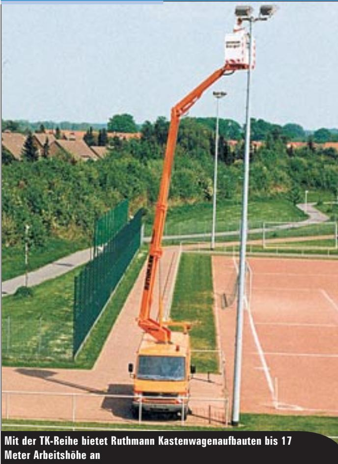
Mit der TK-Reihe bietet Ruthmann Kastenwagenaufbauten bis 17 Meter Arbeitshöhe an
