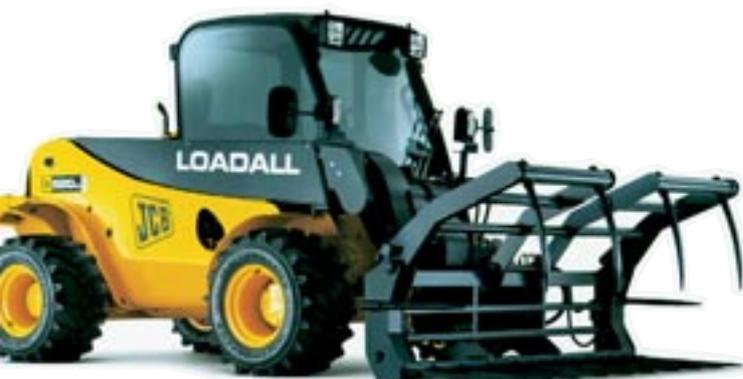
**Deutschlandpremiere haben die Teleskopladernmodelle 520-40 und 515-40 auf der Nordbau gefeiert. Die Maschinen, die JCB in diesem Jahr vorgestellt hat, bieten eine Hubhöhe von vier Metern mit zwei beziehungsweise 1,5 Tonnen maximaler Tragkraft und zeichnen sich durch ihre kompakte Maße von 1,97 Metern Höhe und 1,56 Metern Breite aus.**
