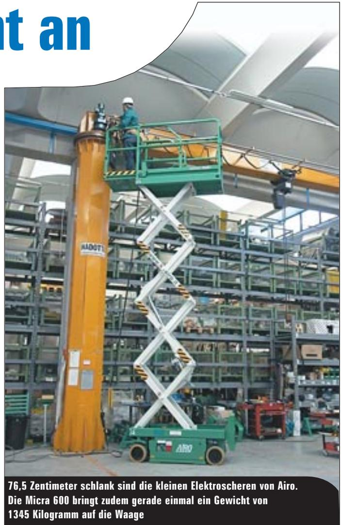
76,5 Zentimeter schlank sind die kleinen Elektroscheren von Airo. Die Micra 600 bringt zudem gerade einmal ein Gewicht von 1345 Kilogramm auf die Waage
