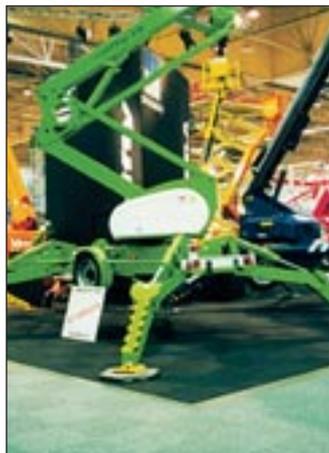
Volle Korblast von 225 Kilogramm bietet die Nifty 210 bis zu einer Reichweite von zwölf Metern
