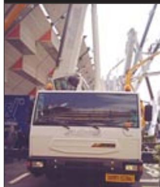
« Auch für den MRT 2540 M-Serie von Manitou war die SAIE der erste öffentliche Auftritt vor großem Publikum. Neben einer Hubhöhe von 25 Metern bietet der drehbare Teleskopplader eine Maximalhubkraft von vier Tonnen. Die erste Maschine ist bereits an ein deutsches Bauunternehmen ausgeliefert, die das Gerät am Frankfurter Flughafen einsetzt.
