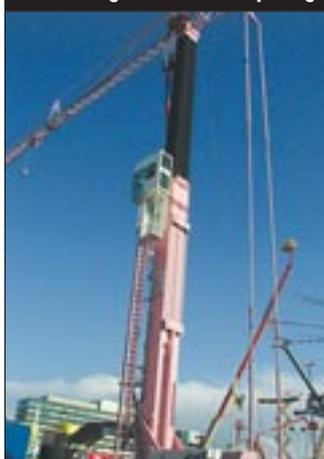
Vor rund drei Jahren hat Liebherr seinen MK 80 vorgestellt. Der Vierachser mit maximal acht Tonnen Tragkraft wird demnächst einen größeren „Bruder“, den MK 100 erhalten. Der neue Fünfsachser, der wieder eine Koproduktion zwischen den Werken in Ehingen und Biberach sein wird, hat voraussichtlich eine Hakenhöhe von 33 Metern und eine maximale Ausladung von 52 Metern. Maximal acht Tonnen, an der Spitze noch 1,6 Tonnen Tragkraft weist das Gerät auf.
