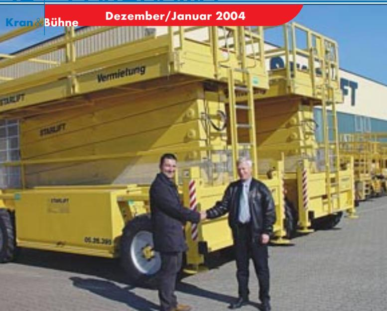
Hans-Dieter Kark, Inhaber von Starlift, hat seiner Arbeitsbühnenflotte zwei Großscheren von Liftlux, der Modelle S 245-250 4WDSP hinzugefügt. Die Dieselgeräte sind mit einer 7,55 mal 2,5 Meter großen Plattform mit 750 Kilogramm Korblast ausgestattet. Kark nahm die Geräte von Thomas Müller, Vertriebsmitarbeiter von Liftlux, entgegen.
