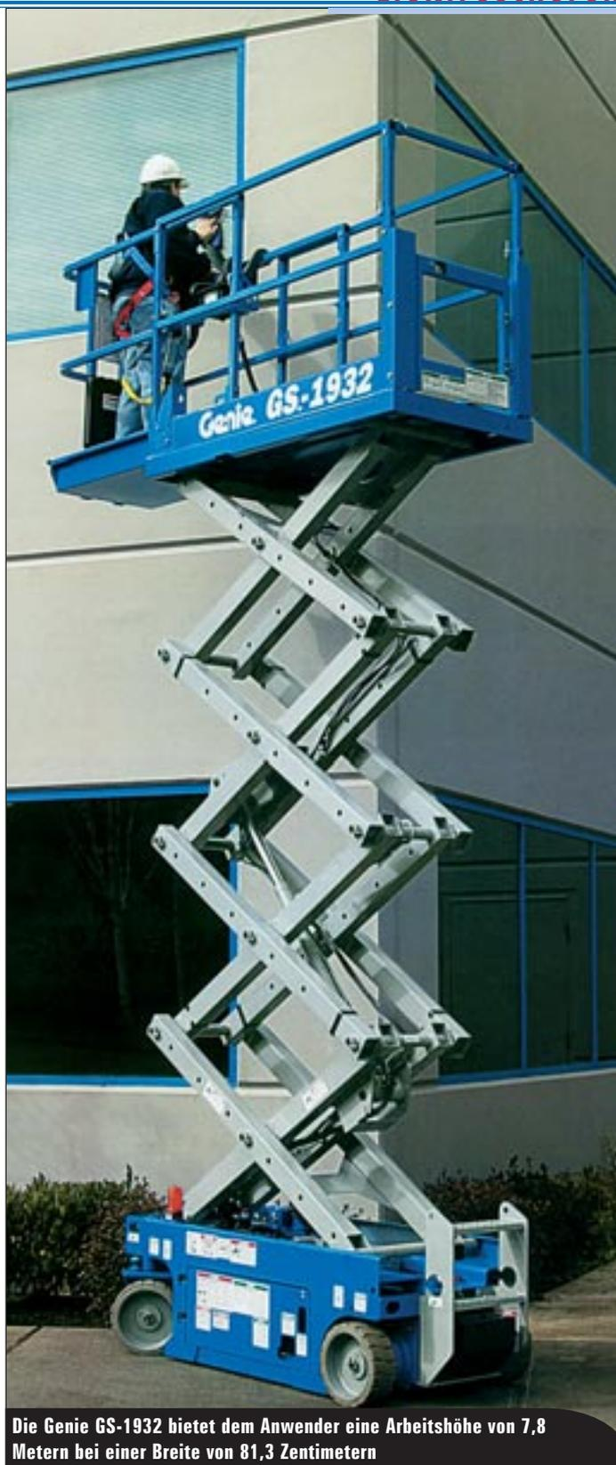
Die Genie GS-1932 bietet dem Anwender eine Arbeitshöhe von 7,8 Metern bei einer Breite von 81,3 Zentimetern
