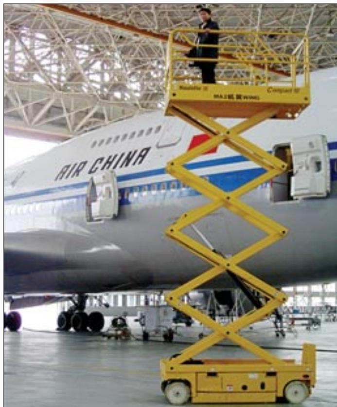
**Mit der Compact 10N hat Haulotte im 10-Meter-Bereich eine Maschine mit 81 Zentimetern Breite in diesem Jahr auf den Markt gebracht an.**
