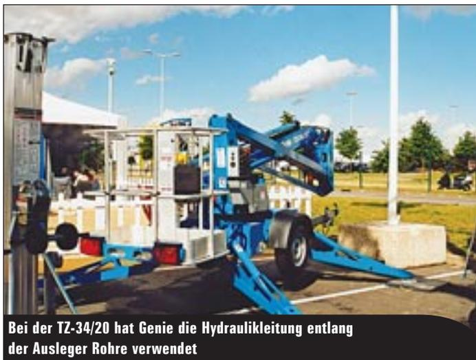
Bei der TZ-34/20 hat Genie die Hydraulikleitung entlang der Ausleger Rohre verwendet
