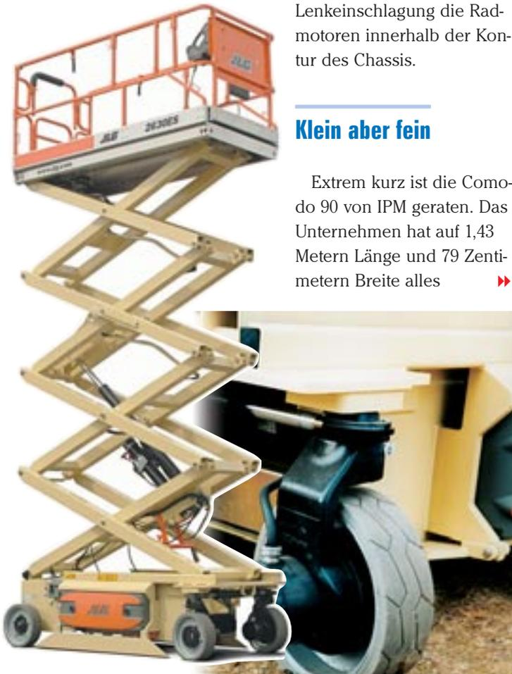
Mit der 2630 ES hat JLG ein 10-Meter-Gerät mit einer Breite von nur 76 Zentimeter auf den Markt gebracht. Die Vorderräder werden direkt angetrieben.
