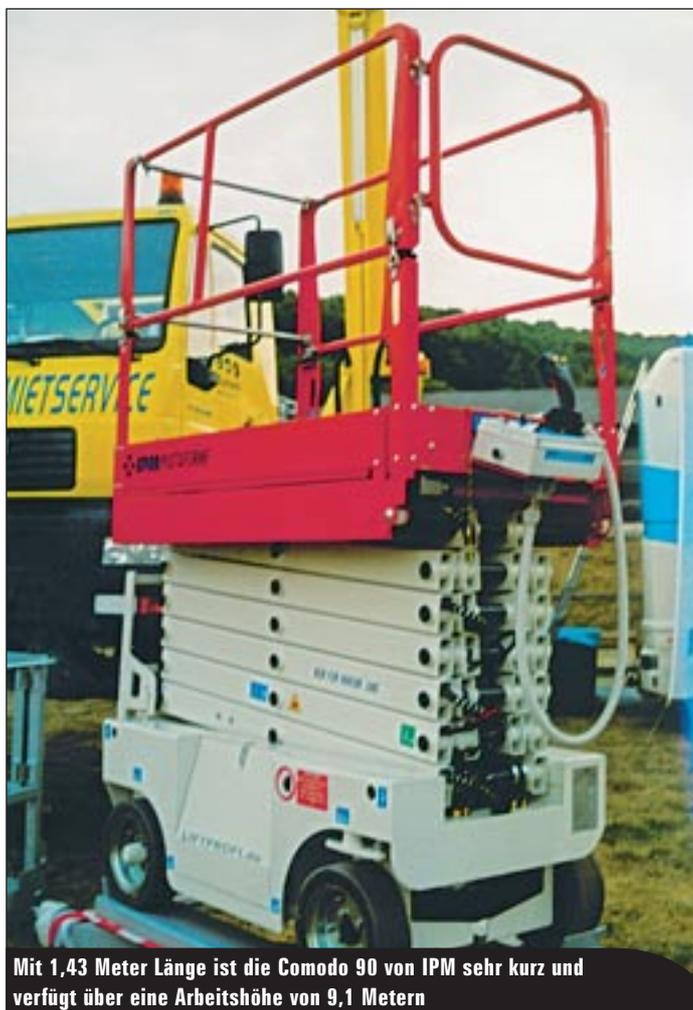
Mit 1,43 Meter Länge ist die Comodo 90 von IPM sehr kurz und verfügt über eine Arbeitshöhe von 9,1 Metern
