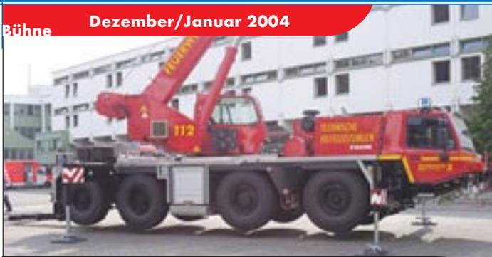
Ein Bergfahrzeug des Typs BKF 40-4 von Tadano Faun mit dem „klassischen“ 22,5 Meter langen Ausleger ist in diesem Spätsommer an die Feuerwehr Wuppertal ausgeliefert worden
