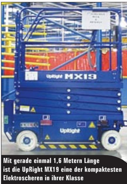
Mit gerade einmal 1,6 Metern Länge ist die UpRight MX19 eine der kompaktesten Elektroscheren in ihrer Klasse
