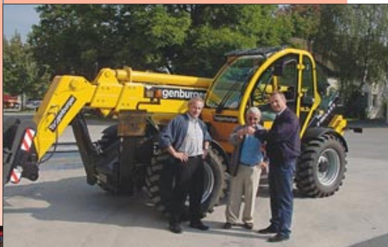
Toggenburger aus Wintherthur hat den ersten Teleskopklader von Faresin-Haulotte erhalten. Die neue Maschine, ein FH 14-35, verfügt über eine Hubhöhe von 14 Metern. Die maximale Traglast von 3,5 Tonnen kann auch mit hochgefahrenem Teleskoparm transportiert werden. Den FH 14-
