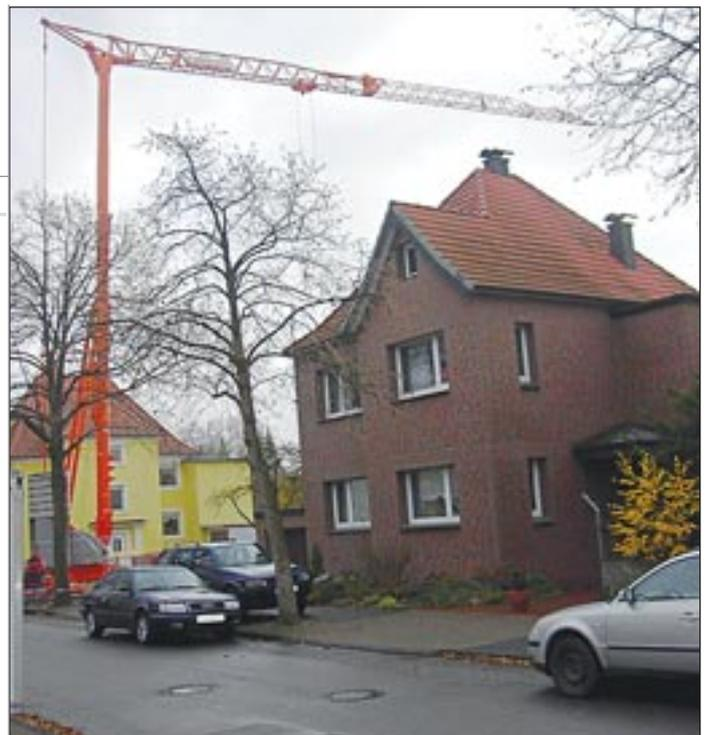
Cadillon hat einen Untendreher entwickelt. Das erste Modell des Chronoflash 30 TL ist bereits für Lütjens Baumaschinen & Gerätehandel GmbH aus Lippstadt im Einsatz. Der Kran kann eine Last von vier Tonnen bis 10,1 Meter bewegen und ist in der Lage, bei einfacher Scherung 1100 Kilogramm bis 30 Meter zu verfahren.
