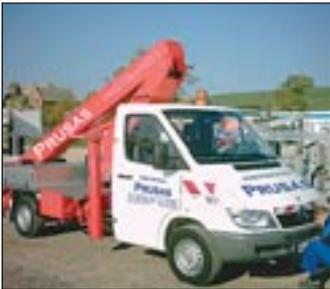
einem 3,5-Tonnen-Sprinter mit einer Arbeitshöhe von 22 Metern auf 3,5 Tonnen ist nach Angaben der neuen Besitzerin eine effiziente Bereicherung des Fuhrparks. „Als für das Vermietgeschäft sehr erfreuliche Neuerung erweist sich die meterweise Teleskopausschubbegrenzung, durch die das Gerät in allen Höhenklassen einsetzbar ist, und die Aufstellautomatik, welche auch unerfahrenen Kunden ein schnelles und sicheres Arbeiten ermöglicht“, erklärt Frau Prusas.
