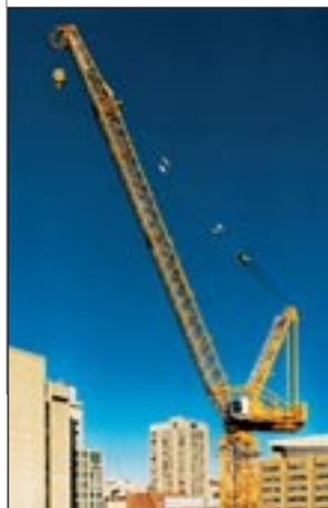
Liebherr's neuer Nadelausleger 540 HC-L 12 arbeitet mit einem Drehkreisradius von 7,5 Metern. Der 65 Meter lange Ausleger kann zwischen 15 und 70 Grad „geparkt“ werden. Seine Tragfähigkeit beträgt 4,8 Tonnen bei 65 Metern Ausladung. Die maximale Traglast mit einer Auslegerlänge von 65 Metern beträgt zwölf Tonnen.
