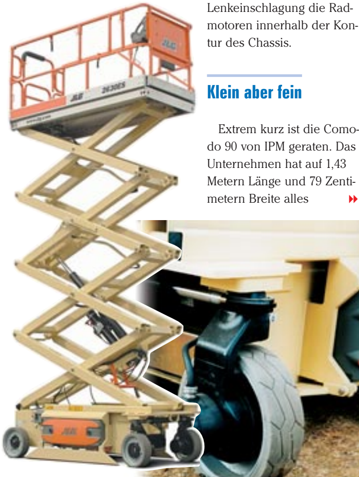
Mit der 2630 ES hat JLG ein 10-Meter-Gerät mit einer Breite von nur 76 Zentimeter auf den Markt gebracht. Die Vorderräder werden direkt angetrieben.
