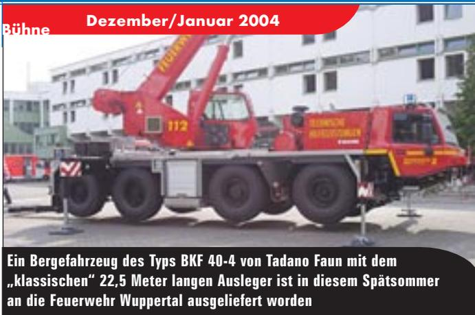
Ein Bergfahrzeug des Typs BKF 40-4 von Tadano Faun mit dem „klassischen“ 22,5 Meter langen Ausleger ist in diesem Spätsommer an die Feuerwehr Wuppertal ausgeliefert worden
