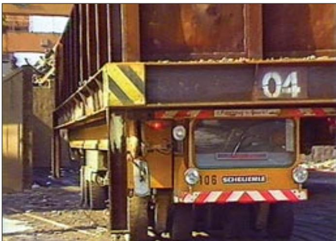
Scheuerle Spezialtransporter sind bereits mehrere Jahrzehnte ein Begriff für Schwertransporte. Ein Farbtonfilm aus dem Jahre 1987 zeigt diese Geräte im Einsatz für die Stahlwerke in Peine, Salzgitter. Für den Transport der Gießpfannen innerhalb des Stahlwerkes kamen die janusköpfigen Scheuerle-Gießpfannentransporter mit einer Nutzlast bis zu 150 Tonnen zum Einsatz. Das Video ist beim Historischen Filmservice, Hamburg erhältlich.
