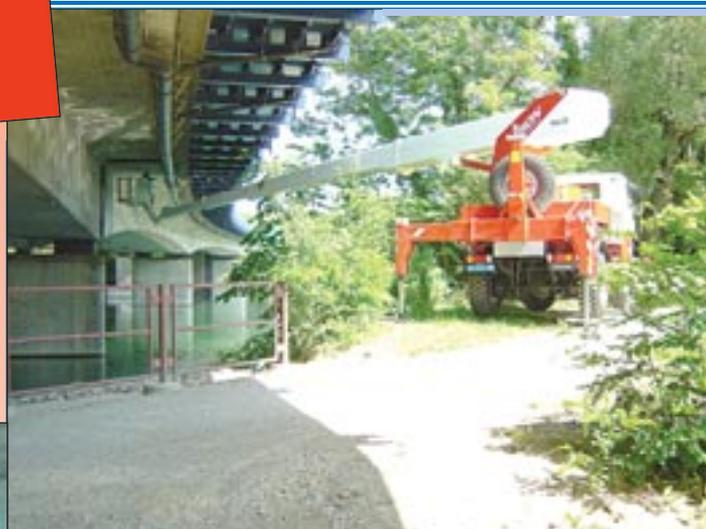
Für Montagearbeiten unter der Autobahnbrücke der A1 bei Neuenhof wählte die Elektroinstallationsfirma Erni + Giger eine Bison TKA 35 KS der Lift-Ex AG. Dabei kam die volle Reichweite von 30 Metern zum Einsatz.
