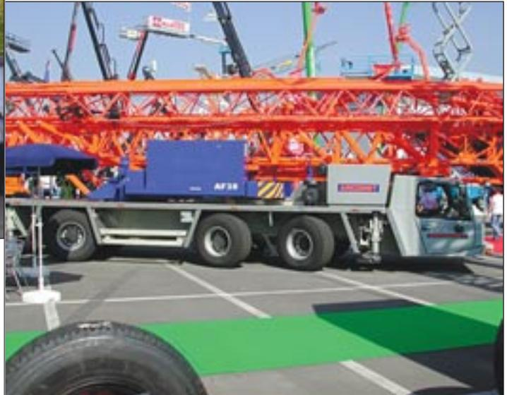
Mit dem Modell AF 38 bietet Arcomet erstmals einen Turmdrehkran aufgebaut auf einem dreiachsigen Faununterwagen an. Der Kran hat eine Hakenhöhe von 23 Meter bei horizontal gerichteten Ausleger und 43,5
