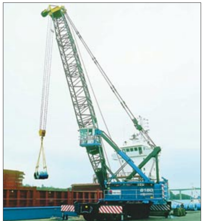
Zwei Stahl-Coils mit einem Gewicht von 47 Tonnen entlädt der Sennebogen 6180 HMC aus einem Feederschiff im dänischen Hafen Vejle
