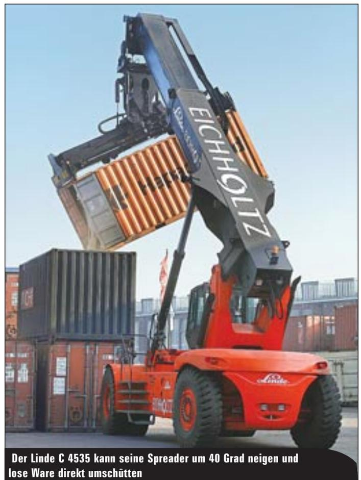
Der Linde C 4535 kann seine Spreader um 40 Grad neigen und lose Ware direkt umschütten
