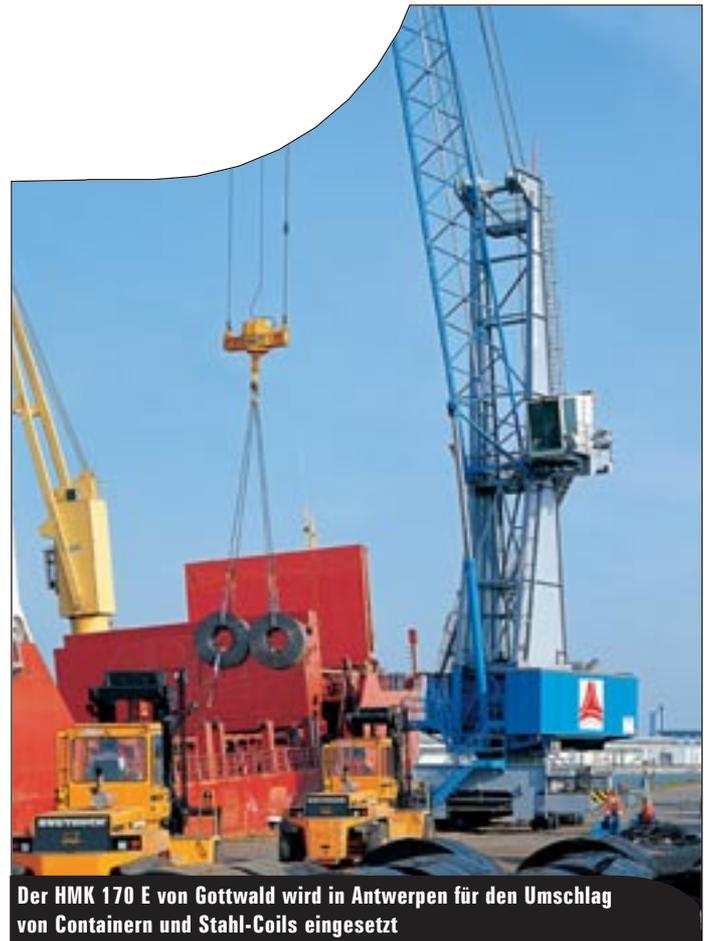
Der HMK 170 E von Gottwald wird in Antwerpen für den Umschlag von Containern und Stahl-Coils eingesetzt
