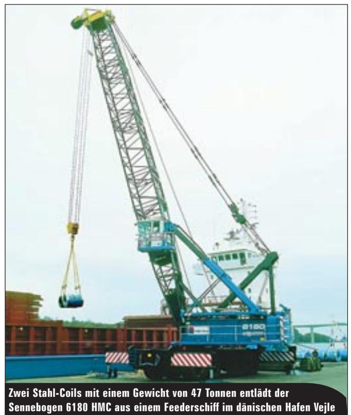
Zwei Stahl-Coils mit einem Gewicht von 47 Tonnen entlädt der Sennebogen 6180 HMC aus einem Feederschiff im dänischen Hafen Vejle
