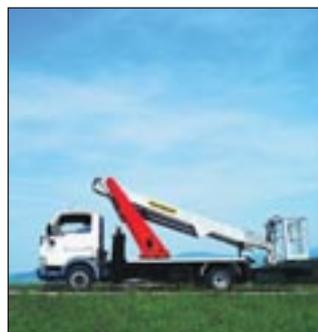
Weltpremiere der LKW-Arbeitsbühne PA20T von Palfinger. Mit dem 20-Meter Teleskop-Gerät auf 3,5-Tonnen-Chassis begibt sich das Unternehmen, dass bisher unter anderem erfolgreich im Bereich der Ladekrane tätig ist, offiziell in das Feld der Hubarbeitsbühnen. Die erste Serie wird durch die PA 13 T und PA 17 T ergänzt.
