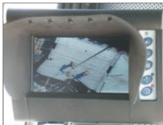
Die Übersicht bei Arbeiten mit einem Turmdrehkran zu behalten, ist für den Kranführer nicht immer leicht. Mit einem Kamerasystem, wie es beispielsweise Orlaco anbietet, steht dem Anwender ein
