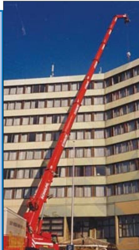
Kranfahrer Michael Lippmann von Scholpp, Stuttgart, nutzte die Möglichkeit den letzten Schübling des Demag AC 60 abzuklappen. Damit sparte der Findige sich die Montage der Klappspitze und konnte trotzdem die Klimaanlage an den Absetzpunkt des Hauses in Stuttgart erreichen.
