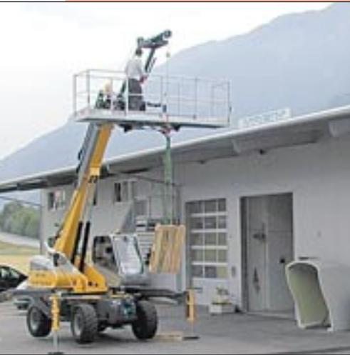
Einen Teleskoplader des Typs Herkules TD 52180 der Firma Jakob hat Robru Arbeitshebebühnen neu in die Vermietflotte aufgenommen. Für das 18-Meter-Gerät stehen verschiedene Anbauteile zur Verfügung, so unter anderem eine fest installierte Seilwinde auf dem Oberwagen bis 4,5 Tonnen Hubkraft oder mit einen Galgen oberhalb des Arbeitskorb installiert. Lasten bis 300 Kilogramm können damit gehoben werden.
