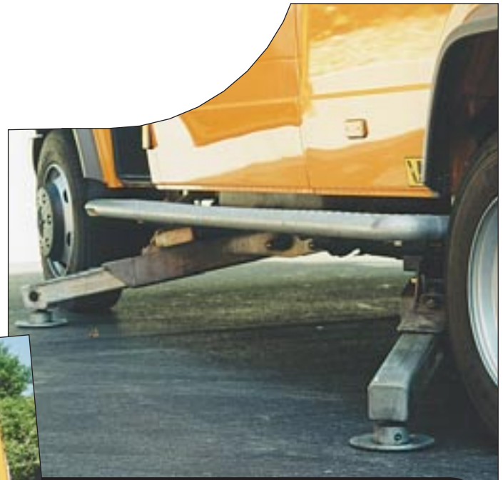
Die Stützen sind komplett unter dem Wagen angebracht. Dadurch wird noch mehr Platz im Innenraum erreicht.
