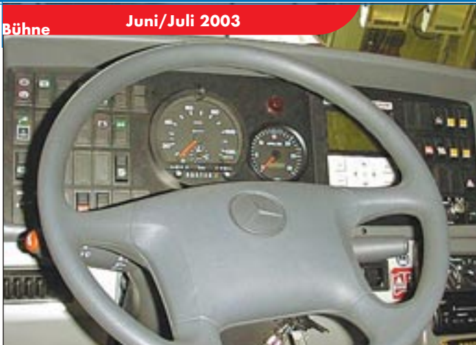
Im Multifunktionsdisplay des „Faun Control & Service System“ werden dem Fahrer weitere Informationen geliefert, wobei die Darstellung der Information der Fahrsituation angepasst ist
