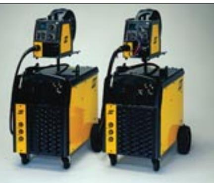
Mit ESABMig 400t und ESABMig 500t steht eine neue Gerätefamilie an Schweißgeräten von Esab zur Verfügung. Bei Umgebungstemperaturen von bis zu 40 Grad Celsius liefert die ESABMig 500t einen Schweißstrom von 500 Ampere bei 60 Prozent Einschaltdauer. Nach Ansicht des Herstellers ist das Gerät für Fülldrahtschweißen mit hohen Abschmelzleistungen prädestiniert.
