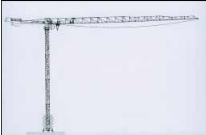
Potains neuer Spitzenloser MDT 178 mit vereinfachter Montage
