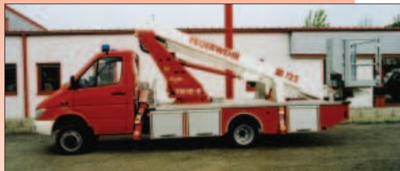
Die Horst Sieghardt GesmbH bietet Hubrettungs Bühnen aufgebaut auf Wumag-Arbeitsbühnen. Das jüngste Produkt ist ein Aufbau auf einer WTF 175. Für das 17,5-Meter-Gerät stehen für Rettungseinsätze nun eine Halterung für eine Krankentrage, eine Lastöse am Hubarm für 300 Kilogramm, zwei Breitstrahler mit je
