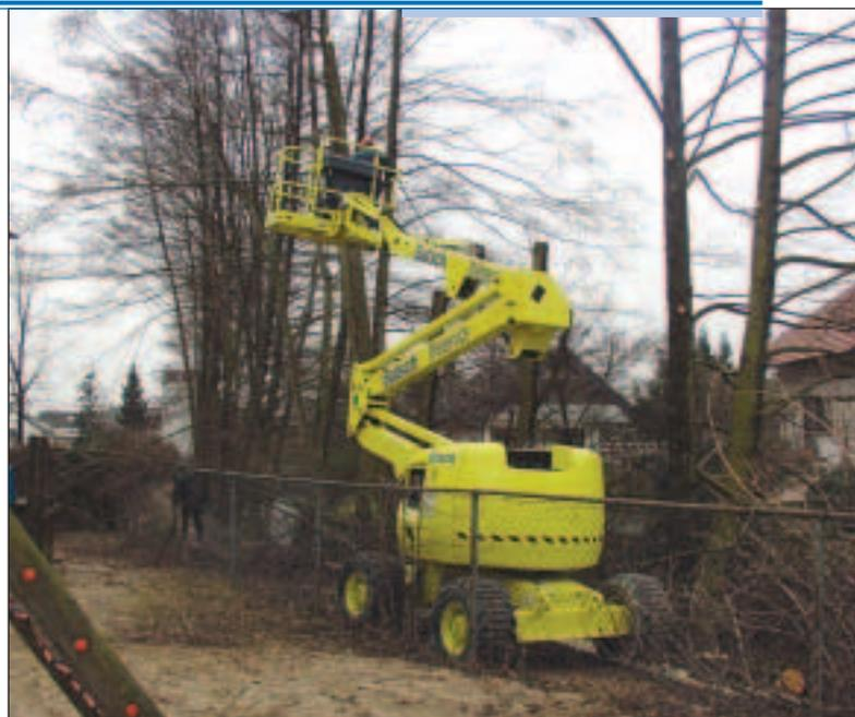
Nur 2,1 Meter Wegbreite standen als Zugang zur Verfügung. Für die Baumschnittarbeiten in rund zwölf Metern Höhe und bis zu vier Metern Ausladung setzte Butsch MietSERVICE auf ihre JLG 450 AJ. Die Geländemaschine war schmal genug und hatte mit 16 Metern Arbeitshöhe sowie 7,4 Metern Reichweite noch ausreichend Leistungsreserven.
