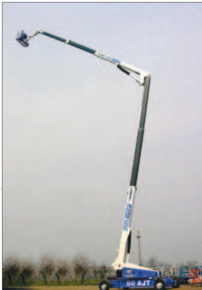
Das italienische Unternehmen Basket hat die nach eigenen Angaben größte selbstfahrende Arbeitsbühne der Welt ausgeliefert. Das spanische Unternehmen ROXU hat das Gerät mit 50 Metern Arbeitshöhe und 26 Metern Reichweite gekauft. Die Basket 50AJT ist mit auf 5,6 Metern ausschließbaren Achsen ausgestattet und wird von einem 78 PS-starken (57kW) Iveco –Motor angetrieben. Auf der Intermat wird die Maschine zu bestaunen sein.
