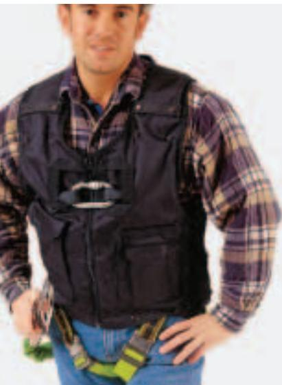
Eine neue Multifunktionsweste wird von Pfeifer angeboten. In der Weste integriert ist ein Aufgangsgurt aus elastischem „DuraFlex“. Der Aufgangsgurt besitzt eine Auffangöse im Schulterbereich, einen Karabinerhaken im Brustbereich, Schnellverschlüsse im Beinbereich und einen vorderen Schnappverschluss. Die Weste mit Aufgangsgurt entspricht nach Herstellerangaben allen Sicherheitsvorschriften und ist nach den DIN EN 361 und 358 geprüft.
