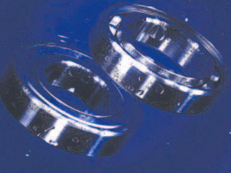
Rillenkugellager aus nichtrostendem Stahl führt SKF im Programm. Diese sind wärmostabilisiert bis 150°, können in Abhängigkeit vom Schmierstoff bis 300° eingesetzt werden. Durch tiefe Laufrillen ohne Einfüllnuten und eine enge Schmiegun zwischen den Laufrillen und den Kugeln können nach Angaben des Herstellers auch Radial- und Axialbelastungen auch bei hohen Drehzahlen aufgenommen werden.
