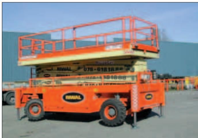
Weiteres TopTen-Mitglied bei „Wer hat den Längsten“: In der Auflistung der Großgeräte wurde das jüngste Modell von Holland Lift, die M-250DL27 4WD/P/N, die zur Apex vorgestellt wurde nicht berücksichtigt. Mit 27 Metern Arbeitshöhe und einer Tragkraft von 1000 Kilogramm gehört die Maschine zu den derzeit zehn größten Scherenbühnen. Holland Lift ist Komplettanbieter von Scherenbühnen zwischen 6,5 und 33,5 Metern.
