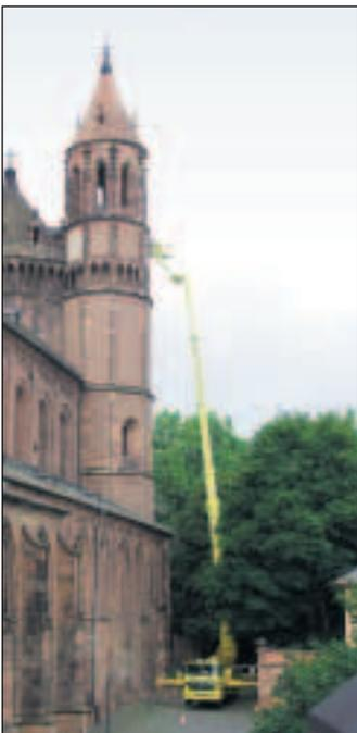
Für stereo-fotogrammetrische Aufnahmen am Wormser Dom setzten die ausführende Ingenieure der Bildmessung GmbH aus Mülheim, Baden, auf den Ruthmann TU 700 von Gardemann. Wichtig für die Aufnahmen, die später ein dreidimensionales Bild des Bauwerks ergeben, ist eine ruhige Fahrt mit dem Korb.
