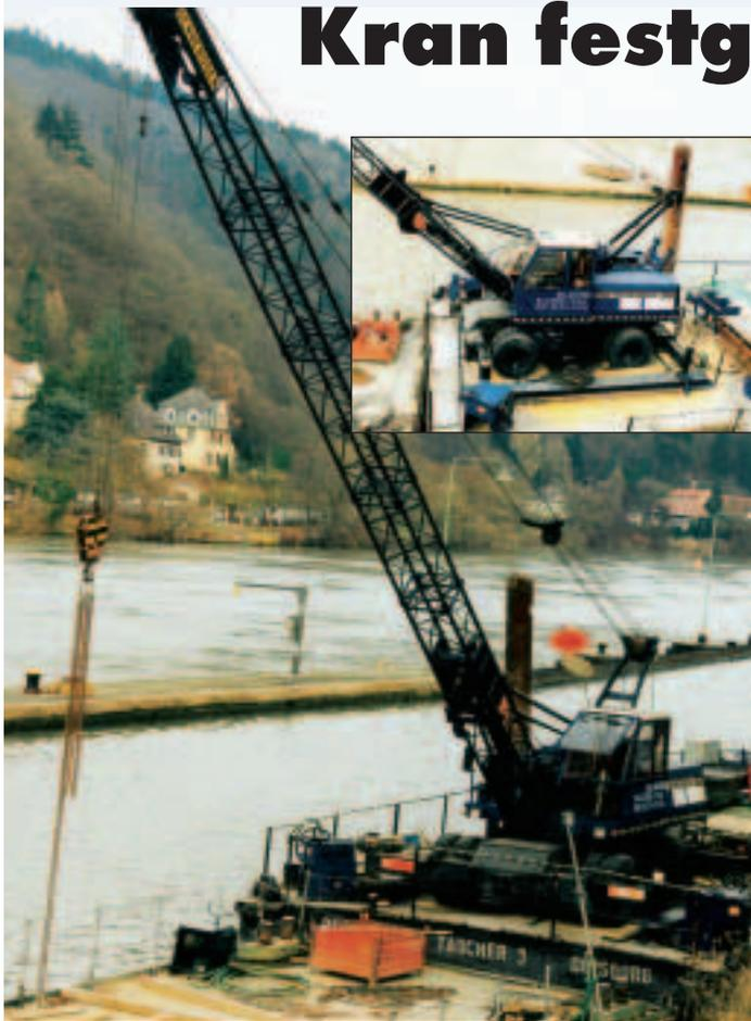
Für den Einsatz auf Deutschlands Binnengewässer hat das Duisburger Unternehmen Unterwasser Technik GmbH den betriebseigenen Sennebogen Mobilkran des Typs 613 mit Gittermastausleger auf ein Ponton installiert. UWT führt von Bergungen über Unterwasserarbeiten mit Stahl oder Beton bis hin zu Sanierungen bestehender Anlagen im Wasser aus.
