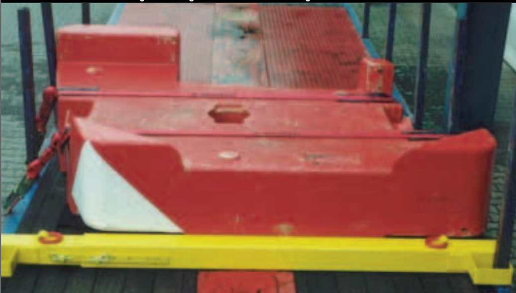
Bild 2: Formschluss mit Ladungssicherungstraverse, zum Patent angemeldet von Brandt-Eura-Krane
