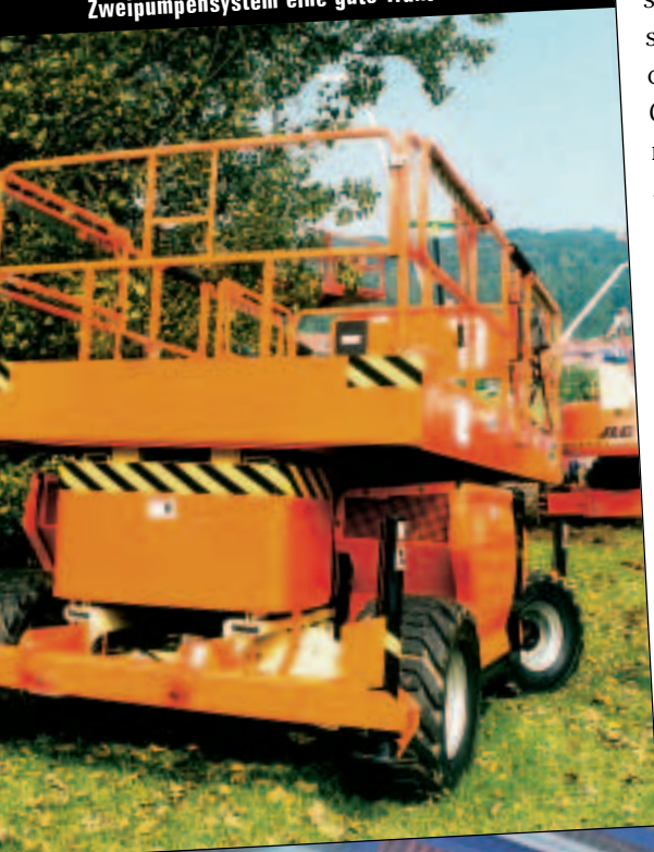
Die neue 3394 RT von JLG erzeugt mit dem Zweipumpensystem eine gute Traktion
