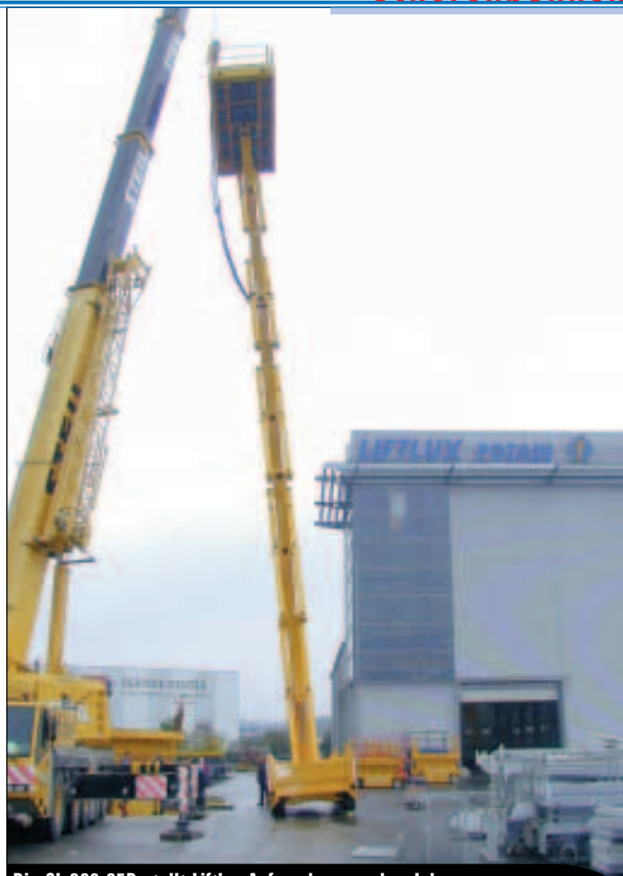
Die SL 260-25D stellt Liftlux Anfang kommenden Jahres vor. Das Gerät wurde dem ANSI-Test unterzogen und in eine Schräge von 5,5 Grad gebracht. Die Scherenpakete lenken dabei nicht aus.
