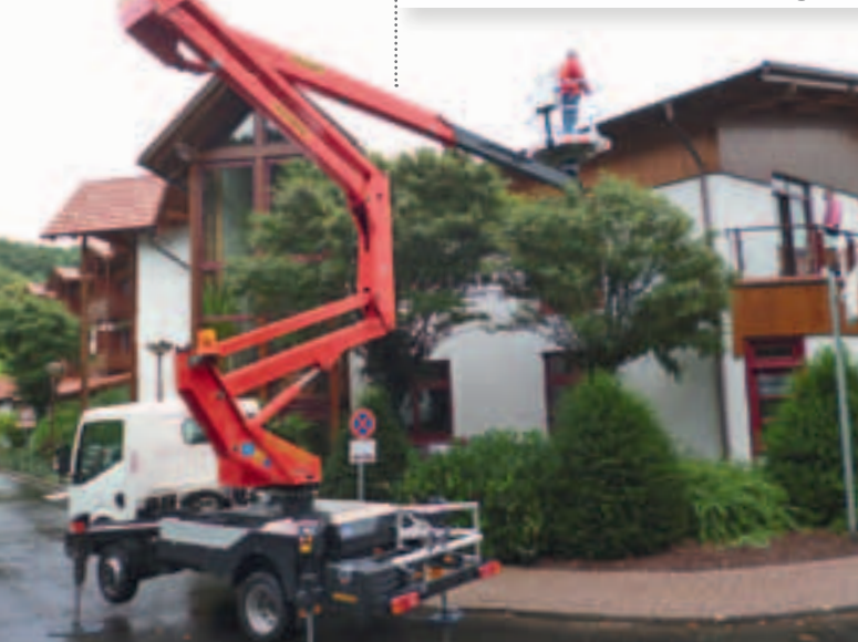
Palfingers P 200 AXE aus der „Smart-Klasse“ ist dank einem Radstand von 2,5 Meter besonders wendig
