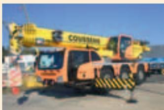
↑ Coussens of Bexhill aus England, auf Kranvermietungen und Schwertransporte spezialisiert, konnte einen neuen Terex Challenger 3160 in Empfang nehmen. Der mit drei Achsen ausgestattete Challenger gehört zur 55-Tonnen-Tragfähigkeitsklasse, verfügt über einen 50 Meter langen Hauptausleger und transportiert sein gesamtes Gegengewicht von 6,8 Tonnen selbst. Damit hat das Unternehmen nun fünf Terex Krane in seinem Fuhrpark.
