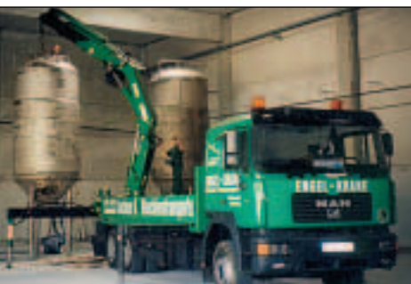
Montagekrane, wie dieser von Fassi, wird hauptsächlich für den Transport und die Montage von Maschinen, Anlagen, und Containern eingesetzt. Ausgestattet mit einer Seilwinde und Funkfernsteuerung wird hier ein sechs Tonnen schwerer Behälter in der Halle aufgerichtet.
