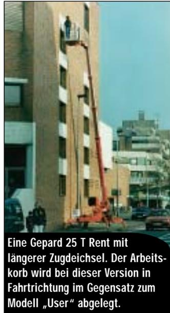
Eine Gopard 25 T Rent mit längerer Zugdeichsel. Der Arbeitskorb wird bei dieser Version in Fahrtrichtung im Gegensatz zum Modell „User“ abgelegt.
