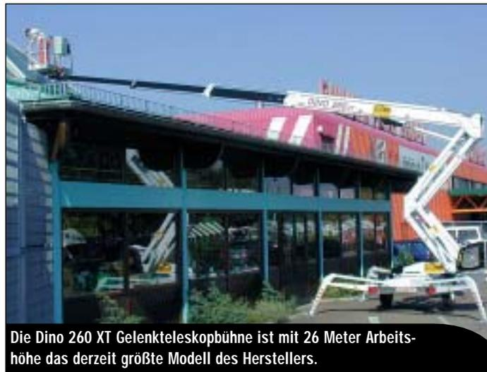
Die Dino 260 XT Gelenkteleskopbühne ist mit 26 Meter Arbeitshöhe das derzeit größte Modell des Herstellers.
