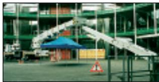
Der LKW-Bühnenhersteller bringt sein Modell S 70 MDT mit. Die 70-Meter-Bühne mit einer Reichweite von 31 Metern kann auf einem 35-Tonner aufgebaut werden.
