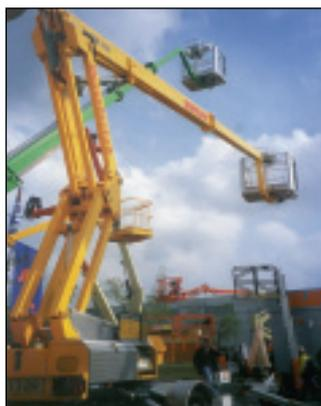
Mit einer neuen Raupenarbeitsbühne überrascht der Hersteller. Mit diesem Teleskopgerät mit Korbbarm und 21,9 Metern Arbeitshöhe und einer Reichweite von zwölf Metern bietet Omme erstmals einen Selbstfahrer an. Darüber hinaus werden auch verschiedene Anhängerbühnen gezeigt werden.
