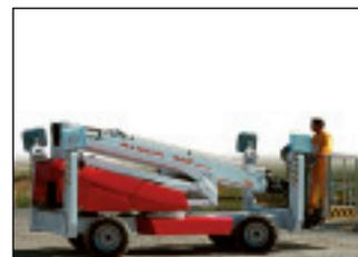
Seinen Neueinsteiger in den Markt der Selbstfahrer, den Rhino 205RXT präsentiert das Unternehmen. Die 20,5-Meter-Bühne hat nach Herstellerangaben ein Eigengewicht von 4,1 Tonnen. Darüber hinaus wird ein Querschnitt aus dem Programm der Anhänger- und LKW-Bühnenbereich mit gebracht.
