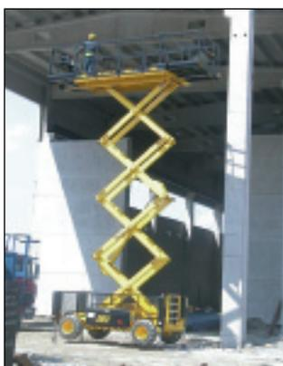
In Maastricht werden drei Scherenbühnen gezeigt. Zum Einen die Elektroschere SF 820 IR E mit 10,2 Metern Arbeitshöhe und 92 Zentimeter Breite. Zum Anderen die SF 1200 D 4WD 2ID Dieselschere mit Dieselantrieb, einer Arbeitshöhe von 14 Meter und Pendelachse.
