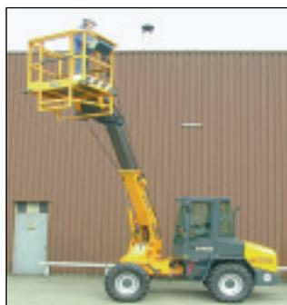
Der Anhängerbühnenhersteller zeigt seine GT 16 A Gelenkteleskopbühne. Darüber hinaus hat der Hersteller als erster den Radlader Multi-TeleStar RL 852 TSL-B mit Arbeitskorb ausgestattet. Das Gerät kann auch vom Korb aus verfahren werden.
