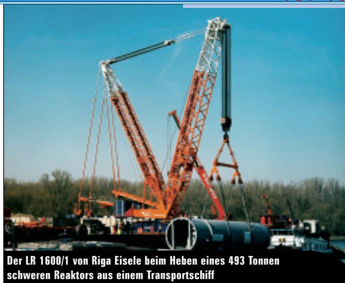
**Der LR 1600/1 von Riga Eisele beim Heben eines 493 Tonnen schweren Reaktors aus einem Transportschiff**
