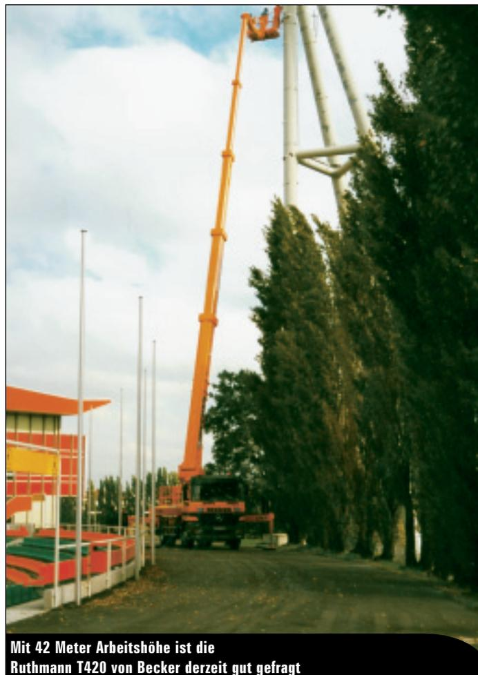
Mit 42 Meter Arbeitshöhe ist die Ruthmann T420 von Becker derzeit gut gefragt
