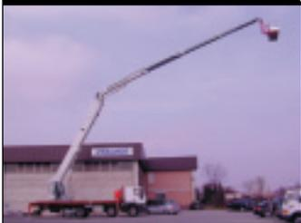
« dass sowohl den ökologischen Aspekt mit der Verwendung von biologisch abbaubaren Ölen verstärkt berücksichtigt, als auch ökonomisch günstig ist. Hierzu wird beispielsweise auch auf preisgünstigere Unterwagen gesetzt. Das neue 19-Meter-Gelenk-Teleskop kann auf ein 3,5-Tonnen-Fahrgestell aufgebaut werden und bietet eine Reichweite von 10,2 Meter. Bison stematec hat die TA 21 jetzt auch als TA 22 im Programm und damit die Arbeitshöhe um einen Meter erhöht bei niedrigerer Korblast.
