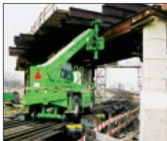
■ Manitou stellt eine neue Baureihe von Teleskopkladern vor. Die vier verschiedenen Modelle der 523er-Reihe zeichnen sich durch eine kompakte Bauweise aus. Alle Geräte haben eine Höhe von 2,01 Metern bei einer Gesamtbreite von 1,8 Metern, der Wenderadius liegt bei 2,89 Metern. Weitere Eckdaten sind eine Hubhöhe von fünf Metern, eine Tragkraft von 2,3 Tonnen und eine Reichweite von 2,87
