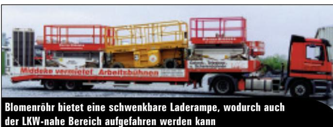
**Blumenröhr bietet eine schwenkbare Laderampe, wodurch auch der LKW-nahe Bereich aufgefahren werden kann**
