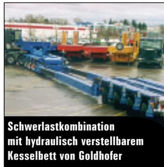
Schwerlastkombination mit hydraulisch verstellbarem Kesselbett von Goldhofer
