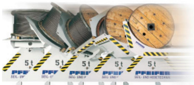
Pfeifer bietet einen neuen Wendetisch an. Das Gerät dient zum Wenden von rotationssymmetrischen Lasten, kann darüber hinaus aber auch für sperrige Objekte verwendet werden. Das Be- und Entladen
