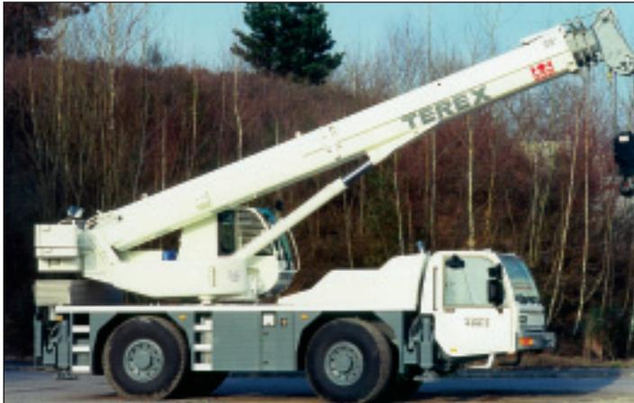
Terex stellt mit dem PPM ATT 400/3 die jüngste Verbesserung des Modells vor. Die wichtigste Änderung ist die verringerte Fahrzeugbreite von 2,55 Meter mit 14.00 oder 16.00-Zoll Bereifung. Mit 2,5 Tonnen Gegengewicht, Hakenflasche und gefülltem Tank liegt das Gewicht des
