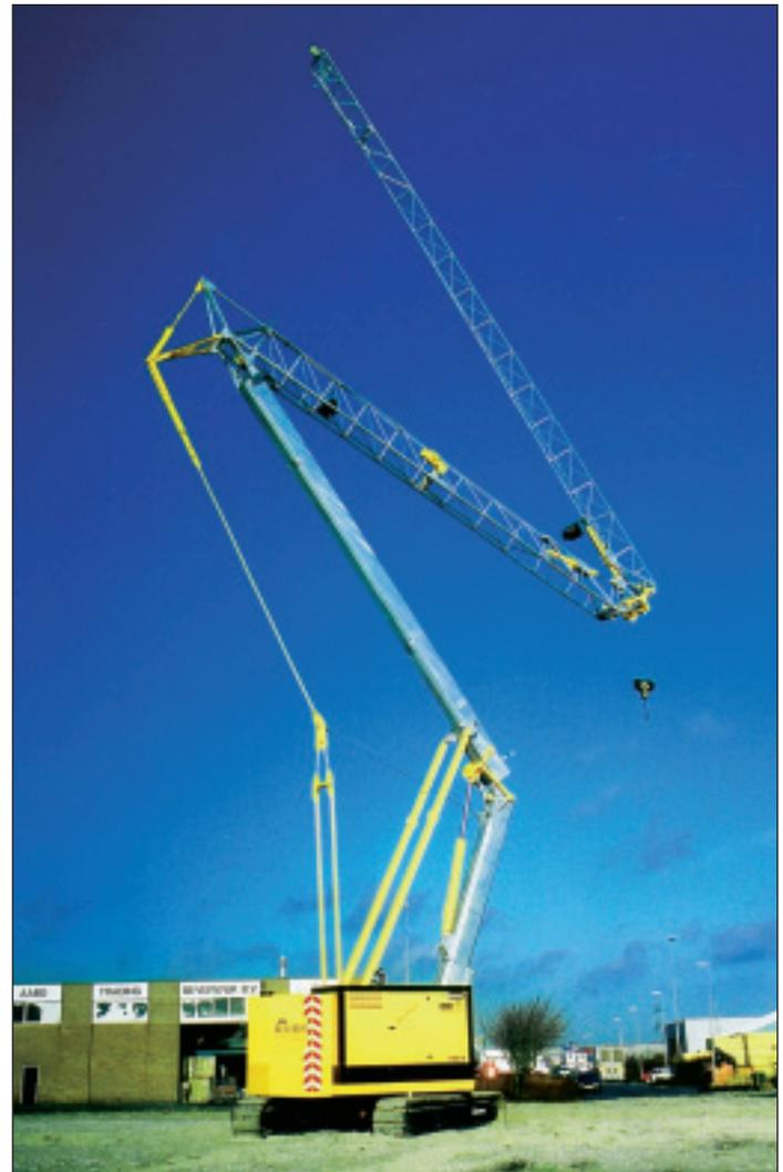
Mit dem neuen Spezialkran Montalift 194 S kombiniert das Unternehmen Monta-Rent einen Schnellmontagekran mit einem Raupenfahrgestell. Der erste Kunde dieses Gerätes ist das Unternehmen Kors aus De Blesse, Niederlande. Der Kran mit 10tm hat eine maximale Traglast von 1500 Kilogramm.
