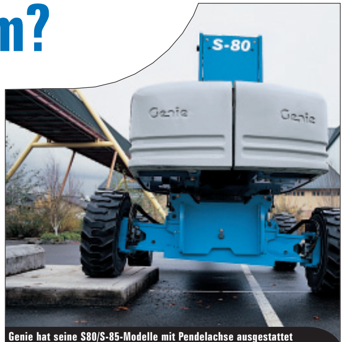
Genie hat seine S80/S-85-Modelle mit Pendelachse ausgestattet
