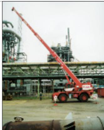
Sie lässt sich mit einer Gitterverlängerung 53,6 Meter erhöhen. Die Verlängerung lässt sich bis zu einem Winkel von 20 Grad neigen, wodurch Arbeiten an Gebäudedakanten oder über Rohrbrücken hinweg erleichtert wird.
