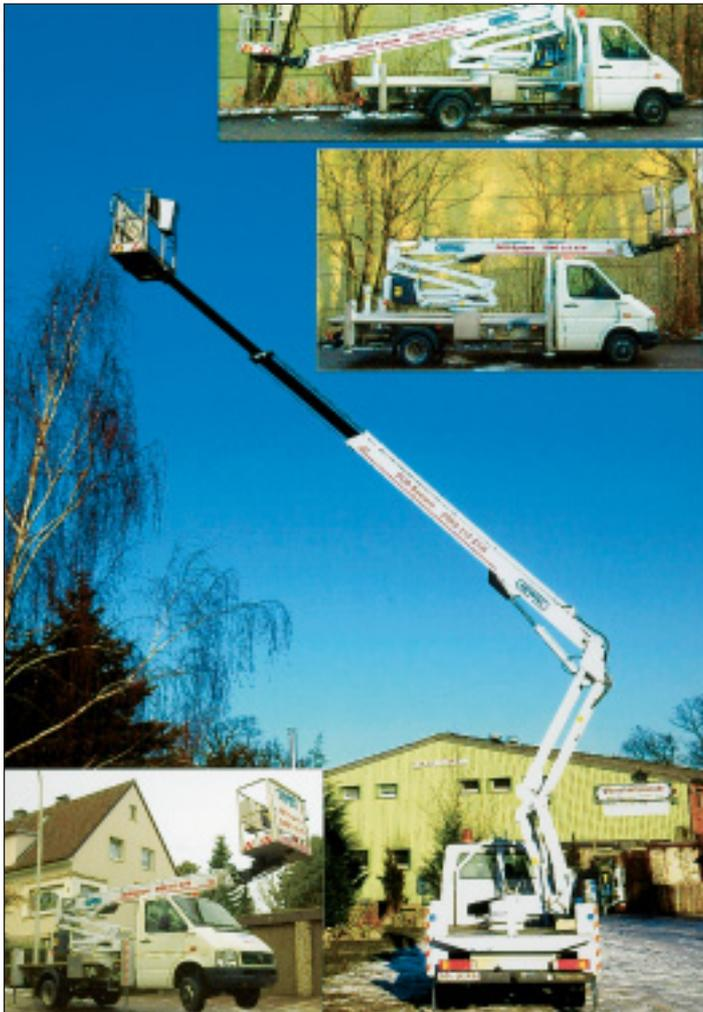
Die norddeutsche Werksvertretung von Dinolift, Hematec Arbeitsbühnen, Dresden, produziert die neue Bühne auf LKW-Basis DINO 215 XTM Duo-System. Das Unternehmen nutzt hierbei die Technologie der Anhängerbühnen von Dino und kombiniert diese als Aufbau auf einem 4,5-Tonnen-Chassis. Die Arbeitsbühne kann wahlweise zur Fahrt nach vorne oder nach hinten abgelegt werden. Dadurch stehen dem Anwender sowohl eine niedrige Durchfahrthöhe von 2,48 Metern als auch eine kompaktere Fahrzeuglänge von 7,3
