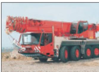
Demag Mobile Cranes hat den AC 80 überarbeitet und mit einigen neuen Detail verbessert. Der neue AC 80-2 erhielt einen stärkeren Motor mit 315 kW. Das Design der Unter- und Oberwagenkabine wurde überarbeitet. Die nun um 18 Grad neigbaren Oberwagenkabine ist mit einer leistungsfähigen Klimaanlage ausgestattet.
