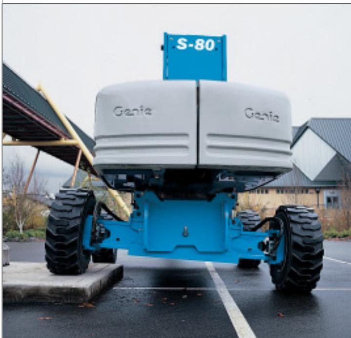
Genie hat seine Teleskoparbeitsbühnen S-80 und S-85 neu überarbeitet und verbessert. Die Geräte sind nun mit dem aktiven Pendelachssystem, das bereits in den S-40- und S-60-Reihen eingesetzt wird, ausgestattet worden. Dieses System arbeitet im gesamten Arbeitsbereich der Maschine permanent.
