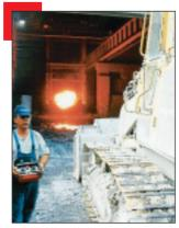
HBC rüstet Baumaschinen für Spezialeinsätze mit Funkfernsteuerung aus um das Arbeiten sicherer zu gestalten. So kommen beispielsweise Laderaupen ferngesteuert in Stahlwerken zum Verteilen heißer Schlacken oder Spezialmaschinen für Abbrucharbeiten im Inneren von Gebäuden zum Einsatz.
