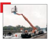
Mit dem Binnenschiff zur Brückeninspektion. Zwei Ruthmann T 355 dienen jetzt bei der Schiffs- und Entwicklungsgesellschaft Travemünde auf Binnenschiffen als Brückenuntersichtsgeräte. Haupteinsatzgebiet werden die Brücken über die Flüsse in den neuen Bundesländern sein.
