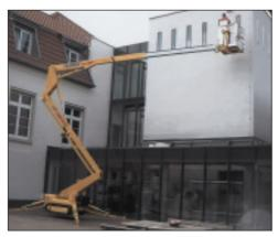
trieb und die Stützarme bedienen. Hydraulische Anlagen und Schläuche sowie die Energieführungskette sind in den Teleskoparm integriert.
