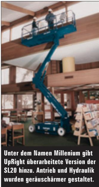
Unter dem Namen Millenium gibt UpRight überarbeitete Version der SL20 hinzu. Antrieb und Hydraulik wurden geräuschärmer gestaltet.
