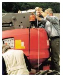
Test. Bei der Reichweite gibt es drei verschiedene Ansichten. Eine Definition ist die reine seitliche Ausladung bis Ende des Korbes mit geradem Korb. Die zweite Möglichkeit ist den, Korb um etwa 90 Grad zu drehen, da so der äußerste Punkt erreicht werde. Bei der dritten Definition wird zur seitlichen Ausladung noch 50 Zentimeter Reichweite des Anwenders hinzugerechnet, ähnlich den zwei Metern Differenz zwischen Plattformhöhe und Arbeitshöhe.
