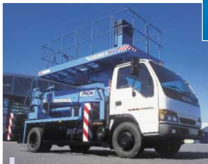
Die Aichi TZ 12A mit einer Tonne Korblast.
