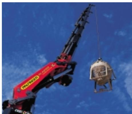
40002 und PK44002 an. Mit Hilfe dieser Technik kann der Knickarm um bis zu 15 Prozent nach oben überstreckt werden.
