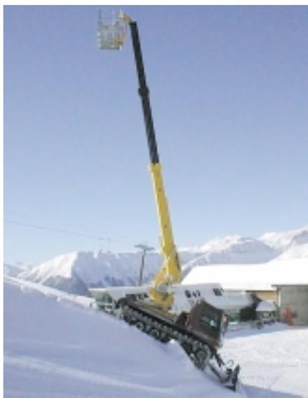
Bestens geeignet für die Einsätze im schweizerischen Bergland ist die Arbeitsbühne auf einem Pistenbully. Das Fahrgestell ermöglicht den Zugang zu abseitigen Gebieten in die keine Straße führt. Entwickelt und produziert wird die Arbeitsbühne P-T 170 von Swisslift.
