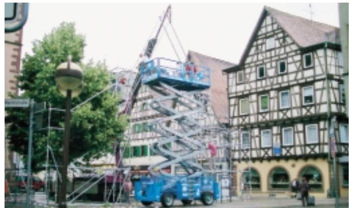
Der Arbeitsbühnenvermieter Seeger aus Rohrdorf nahe Stuttgart hat die erste Großschere des Typs GS5390 von Genie gekauft. Die Vorteile des Gerätes sieht Firmenchef Karl Heinz Seeger in der hohen Stabilität und in der einfachen Wartung des Motors sowie den guten technischen Daten: Acht km/h Fahrgeschwindigkeit, Steigfähigkeit bis 50 Prozent und eine kurze Hubzeit, in 45 Sekunden auf 18 Meter Arbeitshöhe. Erste Einsätze im nahe gelegenen Nagold hat die Maschine bereits erfolgreich gemeistert.
