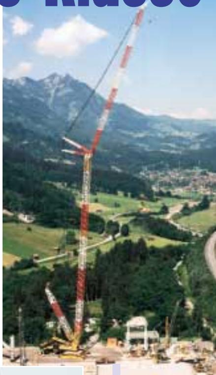
Der LR 11200 ist Liebherr's größter Raupenkran mit 1200 Tonnen Hubkraft.
