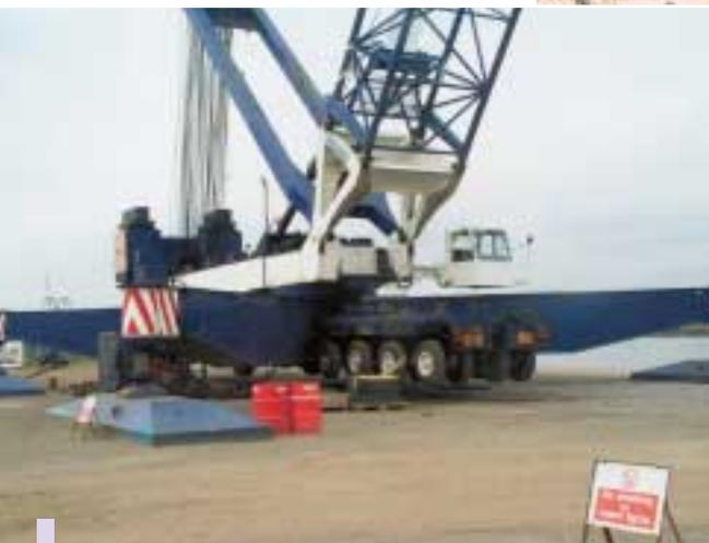
Dieser Krupp K 10001, Baujahr 1971, mit 1000 Tonnen Hubkraft und 93 Meter Hauptausleger steht zur Zeit bei Sindorf in Holland zum Verkauf an.
