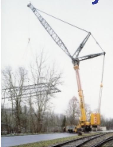
Tonnen Ballast aufgerüstet, da die Last über eine Reihe recht hoher Bäume hinweggehoben werden musste. Mit dieser Konfiguration wurde, bei 43 Meter Ausladung des Kranes, ein 39 Meter langes und 32 Tonnen
